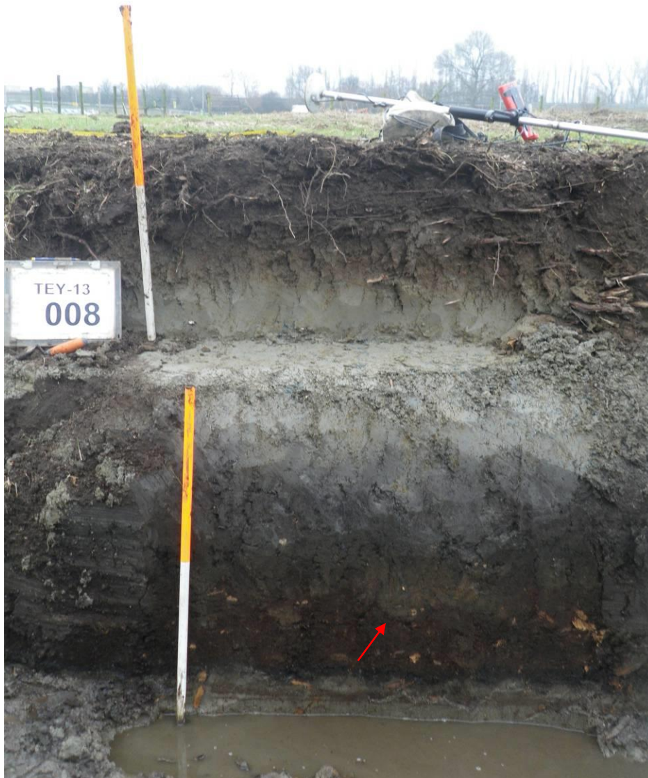
Afbeelding 3.3 profielkolom 6, put 3 (links) en 1, zuidoostprofiel; de rode pijl geeft de overgang van het veraard naar het onveraard veen weer - foto: Grontmij.
